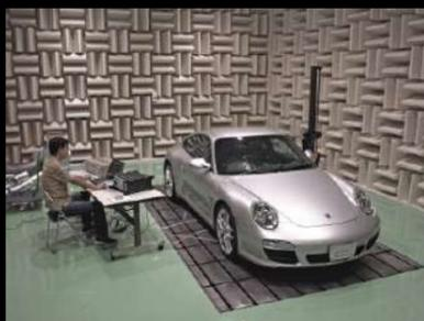
無響箱の使用例： 研究開発者が自分のデスクのすぐ横に、無響室と同レベルの遮音性能を確保した箱を設置することで、無響室で取得した**マスターデータとの相関**を素早く確認することを目的としています。無響室と併用することで研究開発の効率化が図れるが、容積と吸音層の厚みが無響室とは大幅に異なる為、低周波域のデータが異なります。無響室で取得したデータとのレベル差を補正值として、無響箱で測定したレベルに補正する事が可能。無響室とは異なり、規格や明確な基準がない為、あくまでも補助、簡素な目的での使用に向いています。
